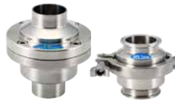
שסתום אל חוזר AISI 304/316L אטם פנימי סיליקון תקן: 3A, DIN
